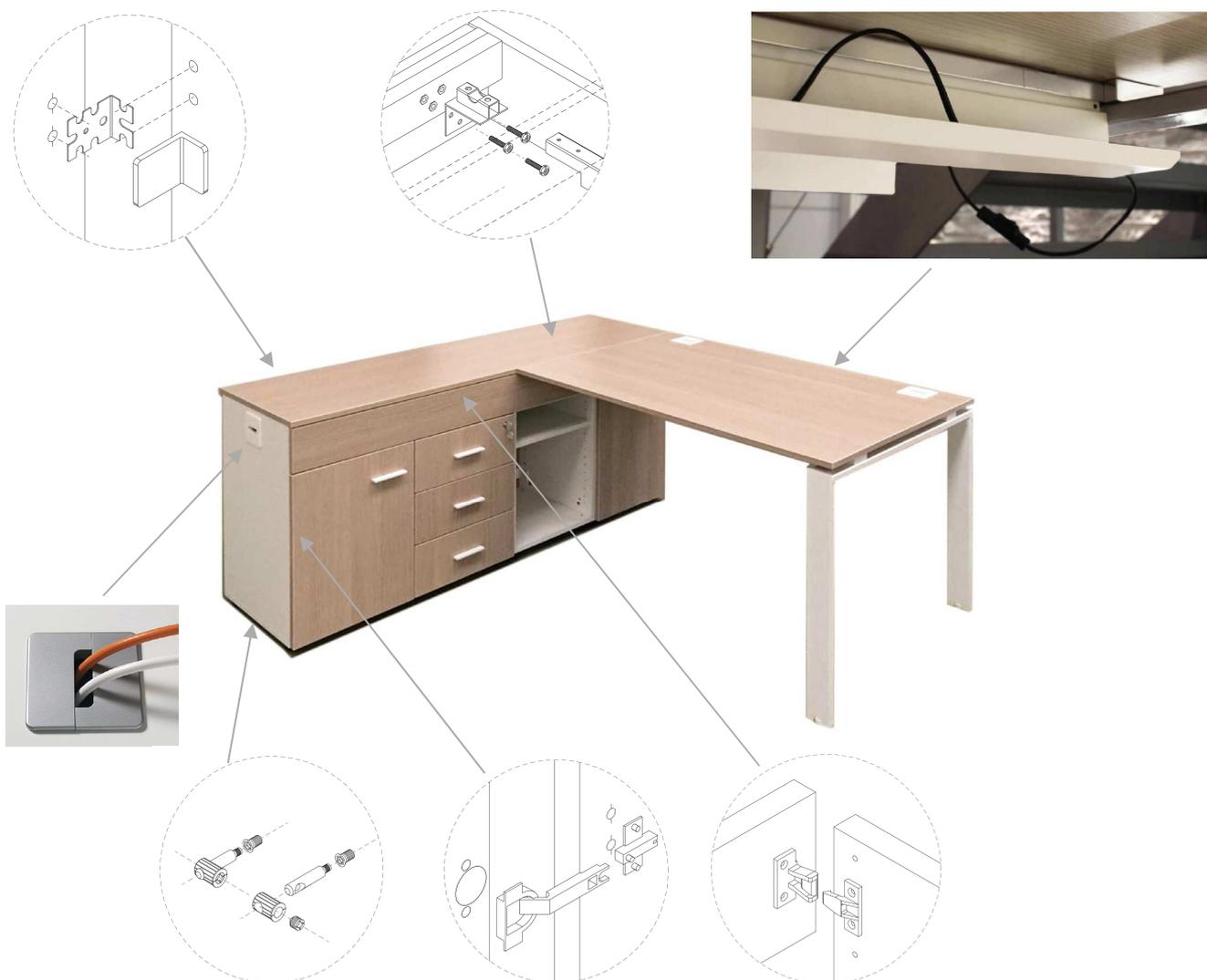
I vari settori – resi solidali tra loro mediante giunzioni passanti - sono concepiti in modo da offrire una intercapedine cablabile sottopiano ( vedi schemi allegati) accessibile mediante opportuni passacavi aventi diametro pari a 80 mm. Tale intercapedine è chiusa mediante una fascia asportabile, fissata alla struttura con appositi ganci che ne permettono la rimozione ed il riposizionamento semplicemente a scatto.
