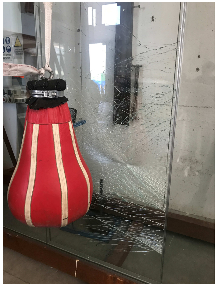
Fotografia dell'oggetto dopo l'urto da corpo molle con rottura conforme della lastra vetrata
