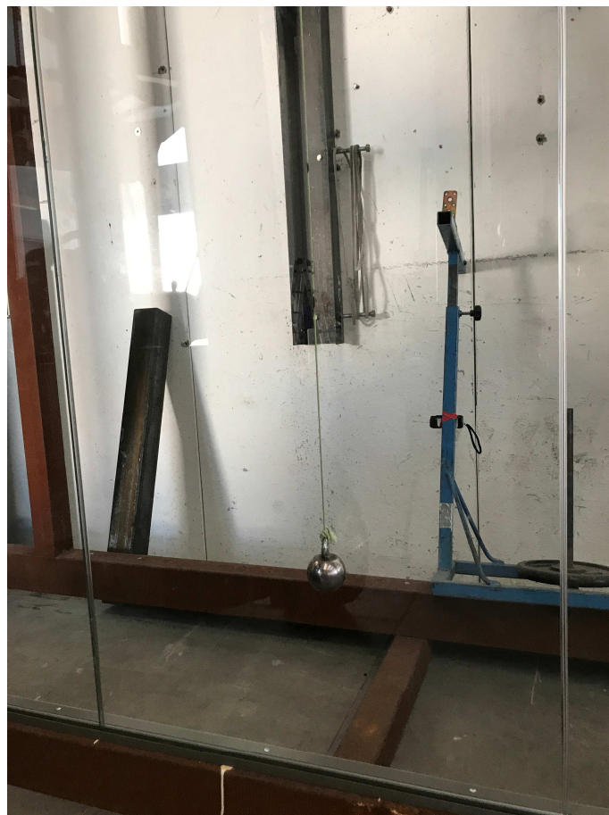
Fotografia dell'oggetto dopo l'urto di sicurezza da corpo duro da 1 kg
