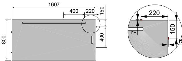
Les aimants **dépassent de 7 mm** de la structure et sont **décalés** par rapport à la barre à laquelle ils sont fixés, afin d'éviter que les aimants de différents bureaux ne se heurtent lorsque deux ou plusieurs bureaux sont assemblés.
