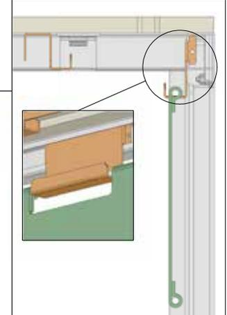
En insérant les **tiges de fer** dans les **œilletons** appropriés, le tissu peut être **accroché des deux côtés**, devenant ainsi **passer-câbles**, car il est positionné exactement **sous la rainure** longue du bureau.
